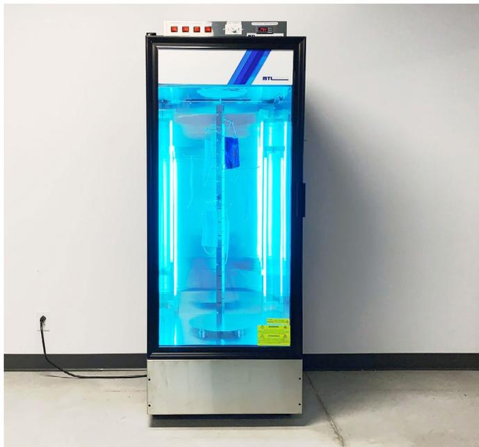
Les rayons UV peuvent être dangereux et par conséquent, l'armoire est dotée **d'une porte en verre double qui bloque les rayons UV** avec un interrupteur de sécurité garantissant que les lumières ne peuvent pas fonctionner lorsque la porte est ouverte.
